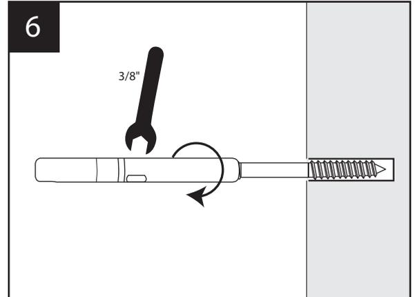
Vissez ensuite, le tensionneur avec une clé de 3/8". Jusqu'au bout du filetage du raccord "B". Laisant un espace entre le tensionneur et le poteau afin de pouvoir tendre votre câble à l'étape #8.
