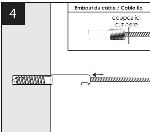
Coupez l'embout (vis) du câble et insérez le câble dans le raccord "A" en le poussant jusqu'au fond (une fois poussé assez loin, il ne ressortira pas).
