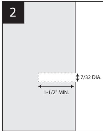
Percez les poteaux avec une mèche de 7/32", minimum 1-1/2" de profondeur (Il est suggéré de commencer par le bas du poteau).
