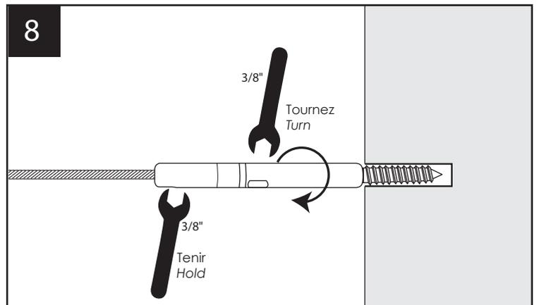
Insérez le câble dans le tensionneur. Tenez le côté gauche avec une clé 3/8" et vissez la partie de droite avec une autre clé 3/8" afin de tendre votre câble.
