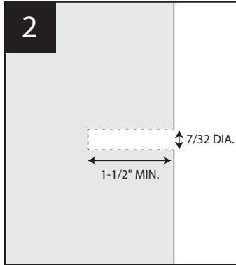
Percez les poteaux avec une mèche de 7/32", minimum 1-1/2" de profondeur (Il est suggéré de commencer par le bas du poteau).
