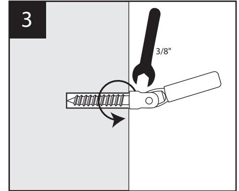
Vissez le raccord "A" dans le premier trou que vous avez percé. Vissez jusqu'au bout avec une clé de 3/8" (10 mm).
