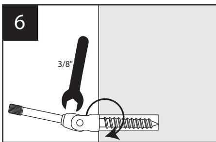
Vissez le raccord "B" dans le trou de votre prochain poteau. Vissez jusqu'au bout des filets de la vis avec une clé de 3/8".
