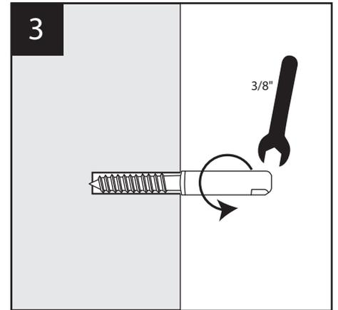
Vissez le raccord "A" dans le premier trou que vous avez percé. Vissez jusqu'au bout avec une clé de 3/8" (10 mm).
