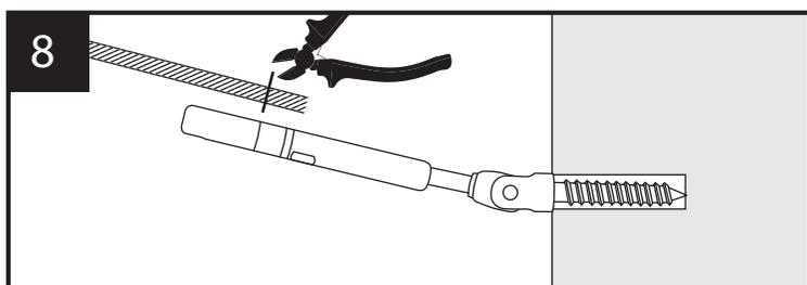
Prenez le câble, qui est déjà installé dans le raccord "A" et tendez le jusqu'au-dessus du tensionneur. Coupez le câble, avec une cisaille à métal pour câble, vis-à-vis la première ligne sur le tensionneur.
