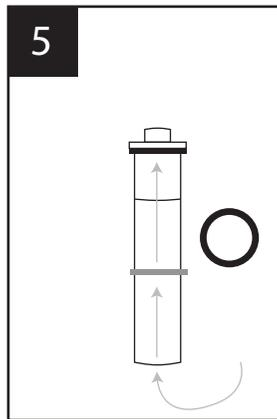
Glissez la rondelle de caoutchouc sur le raccord "B".
