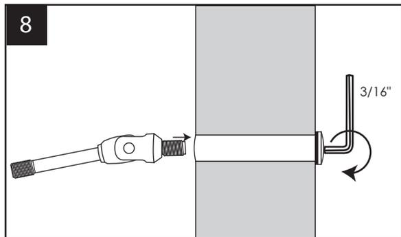
Vissez le raccord "A" avec le raccord "C" à l'aide d'une clé hexagonale.
