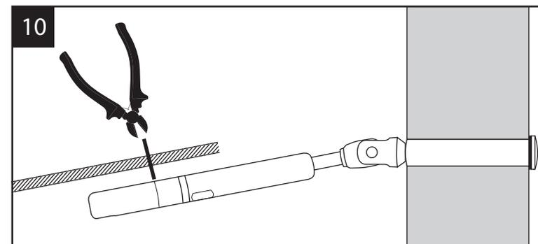
Prenez le câble, qui est déjà installé dans le raccord "A" (Poteau de départ) et tendez le jusqu'au-dessus du tensionneur. Coupez le câble, avec une cisaille à métal pour câble, vis-à-vis la première ligne sur le tensionneur.
