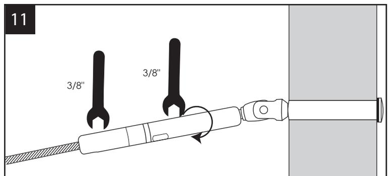
Insérez le câble dans le tensionneur. Tenez le côté gauche avec une clé 3/8" et vissez la partie de droite avec une autre clé 3/8" afin de tendre votre câble.
