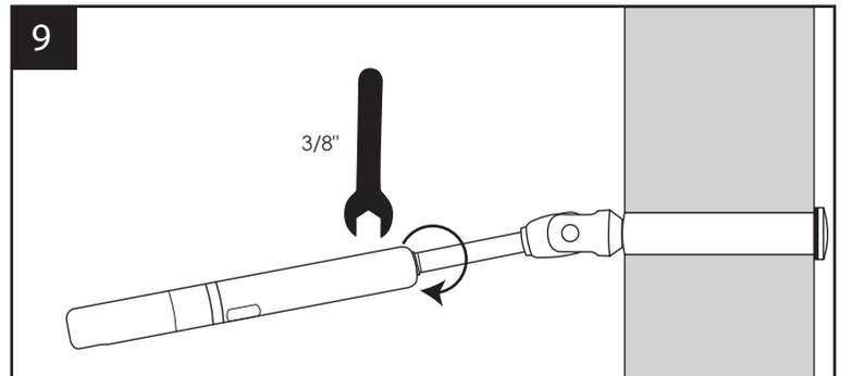
Vissez le tensionneur jusqu'au bout du filetage du raccord "C" à l'aide d'une clé 3/8".
