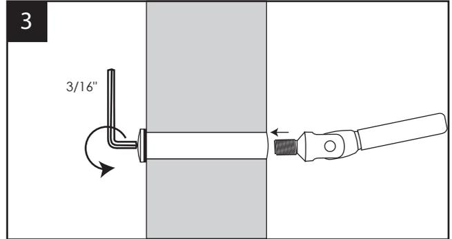
Vissez le raccord "A" avec le raccord "B" à l'aide d'une clé hexagonale.
