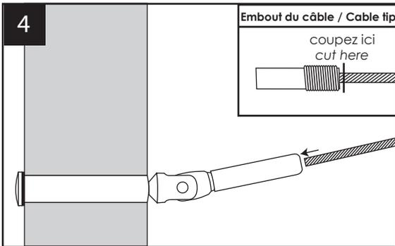
Coupez l'embout (vis) du câble et insérez le câble dans le raccord "B" en le poussant jusqu'au fond (une fois poussé assez loin, il ne ressortira pas).
