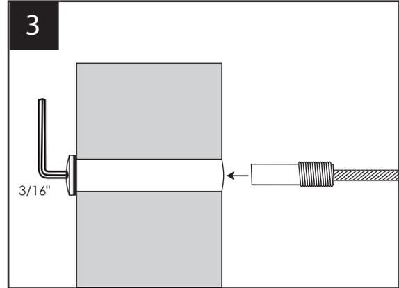
Vissez le raccord "A" avec l'embout du câble à l'aide d'une clé hexagonale. Ne faites que quelques tours afin de vous laissez du jeu pour faire l'ajustement final (voir point 9).
