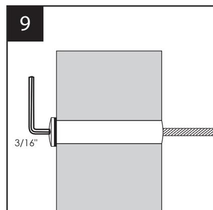
Faites l'ajustement final de votre câble en vissant le raccord "A" à l'aide d'une clé hexagonale.
