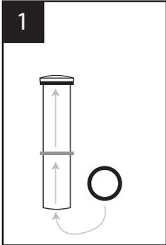
Glissez la rondelle de caoutchouc sur le raccord "A".
