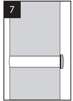
Insérez le raccord "A" dans le trou pré-percé du poteau de fin.
