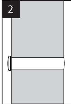
Insérez le raccord "A" dans le trou pré-percé du poteau de départ.
