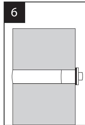
Insérez le raccord "B" dans le trou pré-percé du poteau de début.
