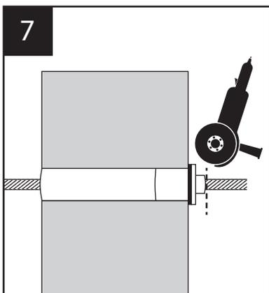
Faites glisser votre câble dans le raccord "B" et tirez sur le câble afin de lui donner la bonne tension. Coupez le câble, avec une meuleuse d'angle, égal au bout du raccord "B".
