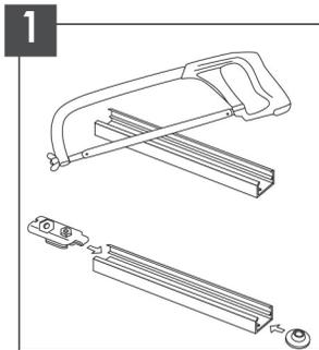
Coupez les deux rails à 2 mm (1/16") de moins que la largeur de l'ouverture. Insérez les ancrages à pivot ainsi que les patins glissant dans les rails. Vissez en place le rail du haut et mettez l'autre rail au plancher.
