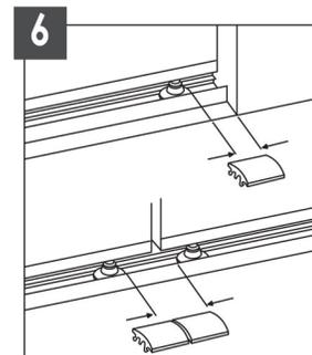
Déterminez la longueur du caoutchouc requise, puis coupez-le avec un couteau bien aiguisé et insérez-le en place sur le rail.
