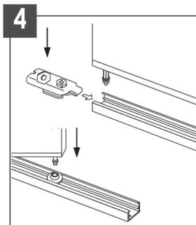
Insérez le pivot ajustable dans l'ancrage au rail du plancher, ensuite appuyez sur le pivot du haut pour qu'il puisse se fixer dans le patin glissant à l'intérieur du rail. Fermez la porte, et répétez la même opération pour les deux autres pivots.
