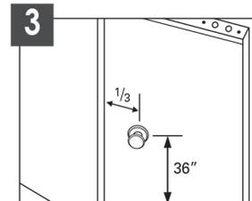
Sur le panneau amovible, fixez la poignée à 36" du bas et en largeur, à partir de la bordure pliante, à 1/3 du panneau.
