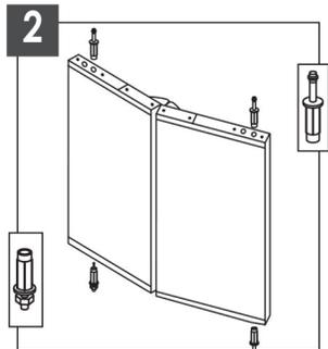
Insérez les pivots dans la porte. Le pivot avec le boulon ajustable doit être placé au bas de la porte tandis que les autres pivots à ressorts sont insérés aux trois autres coins.
