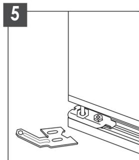
Pour ajuster la hauteur, vissez ou dévissez le pivot avec le boulon ajustable. L'ajustement latéral se fait avec l'ancrage du haut et du bas.
